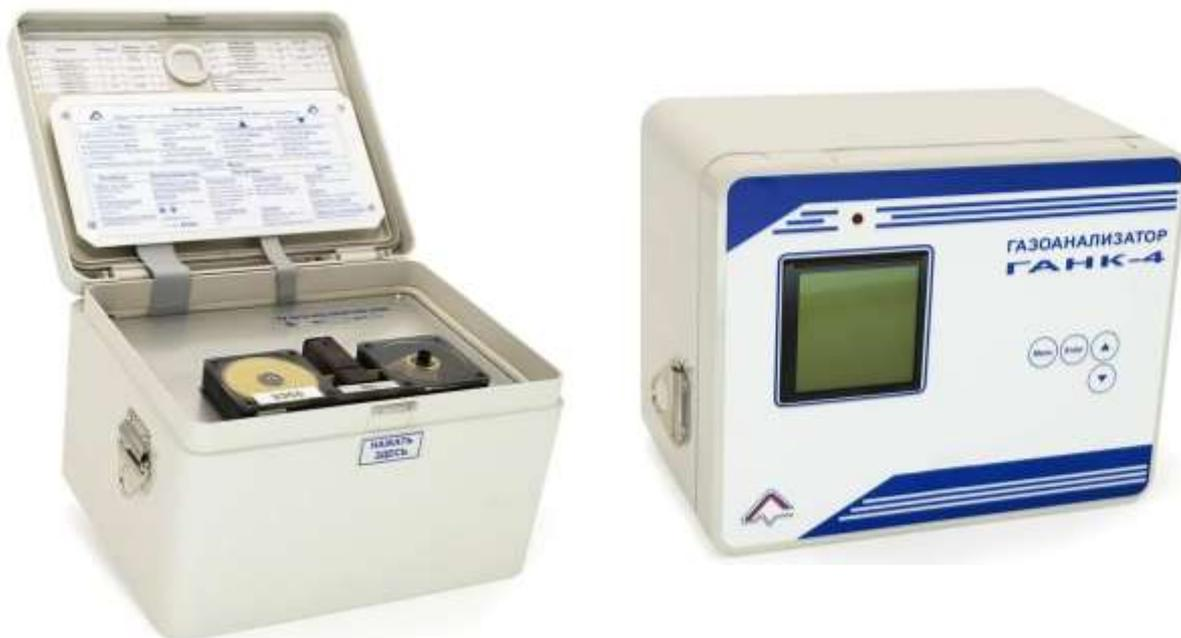
Переносной автоматический газоанализатор **ГАНК-4** (А, Р, АР) с принудительным отбором проб воздуха, предназначен для измерения концентрации загрязняющих и вредных химических веществ, содержащихся в атмосфере, в воздухе рабочей зоны, в замкнутых помещениях и в промышленных выбросах.
