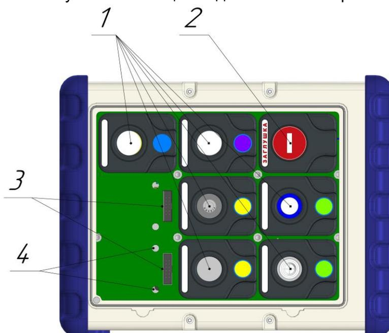
Рисунок 7.3 – отсек датчиков
