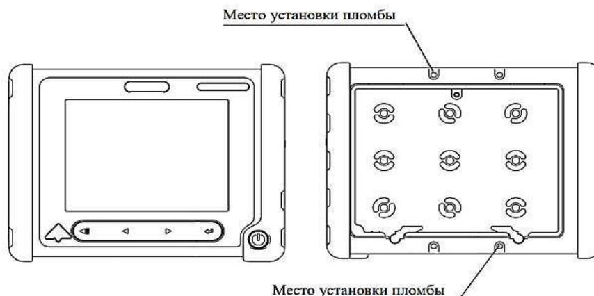
Рисунок 5.1 – Схема пломбировки
