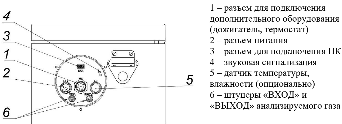
Рисунок 10 – Вид на разъемы
