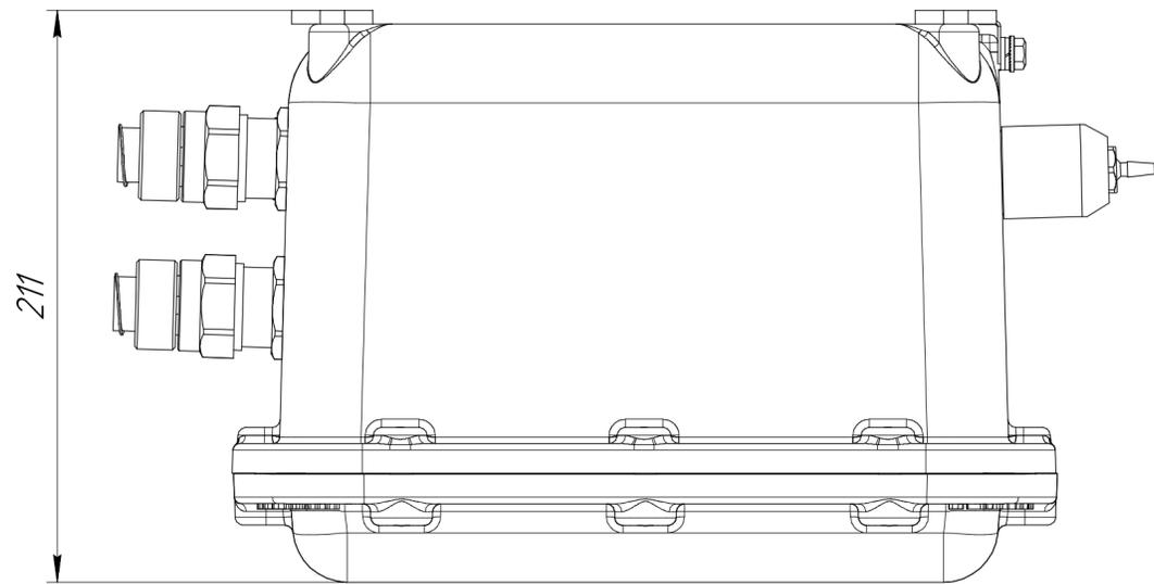
1. Взрывозащита вида 1Ex d IIC T5 Gb X
