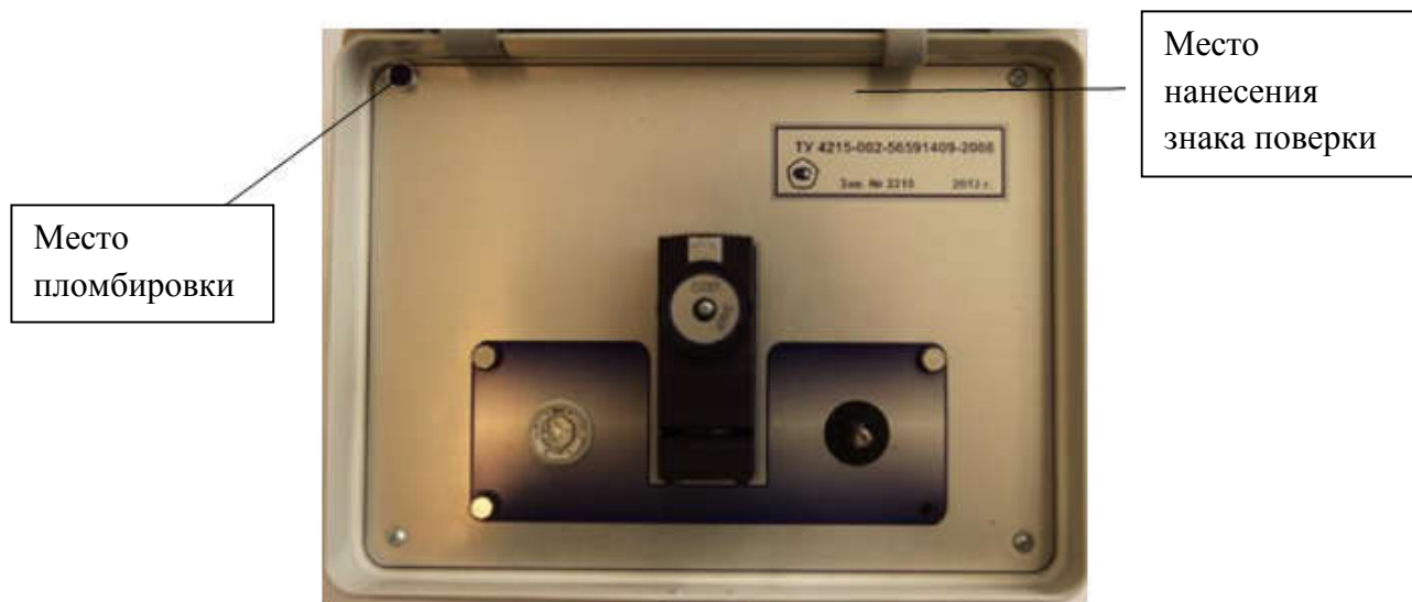
Рисунок 6 – Схема пломбировки от несанкционированного доступа и обозначение места нанесения знака поверки
